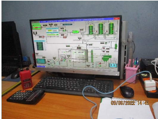
รูปที่ 4 การติดตั้งระบบ SCADA
