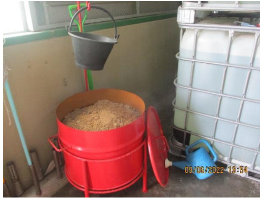
รูปที่ 45 ถังทรายสำหรับดูดซับ
